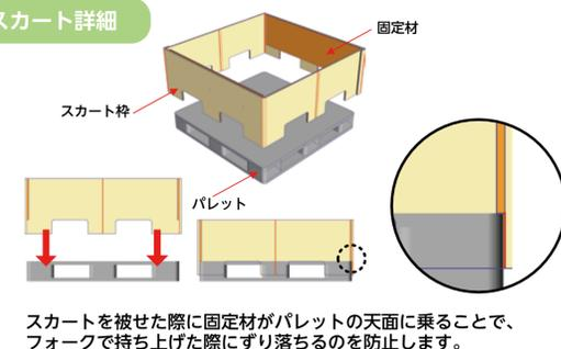
スカートを被せた際に固定材がパレットの天面に乗ることで、フォークで持ち上げた際にずり落ちるのを防止します。
