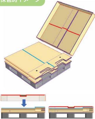
パレットにスリーブとスカートを載せてキャップを被せることで省スペースでの保管が可能となります。
