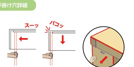
手穴を引っ張ることで折れ線部分がキャップにはまり箱が完成します。
